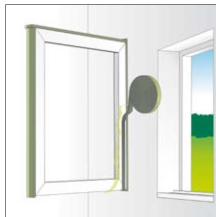
Afbeelding 4: buitenste afdichting met illmod 600
