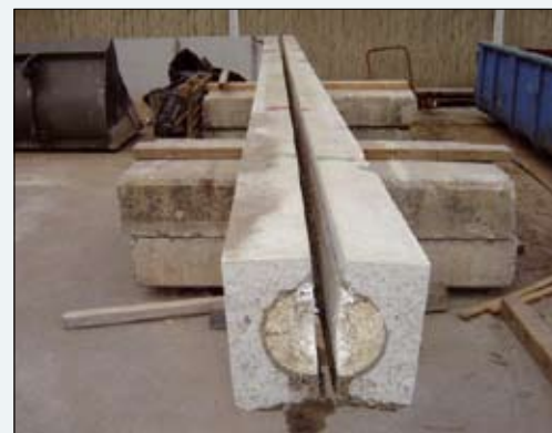
↑ Foto 1 Gezaagde paal
