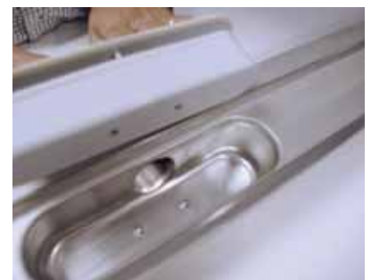
Foutloos terug te plaatsen door centrepunten.
