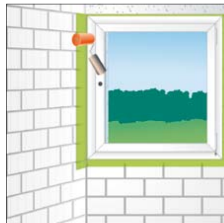
Fig. 5: bevestig het membraan op de muur
